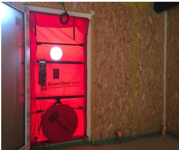
Ce test est réalisé à l'aide d'une porte soufflante souvent appelé blower door qui se compose d'une toile nylon, d'un cadre réglable monté sur l'une des ouvertures du bâti, d'un ventilateur qui permet de mettre le bâtiment en dépression ou surpression, d'un capteur de pression ainsi qu'un ordinateur qui pilote l'ensemble.).
